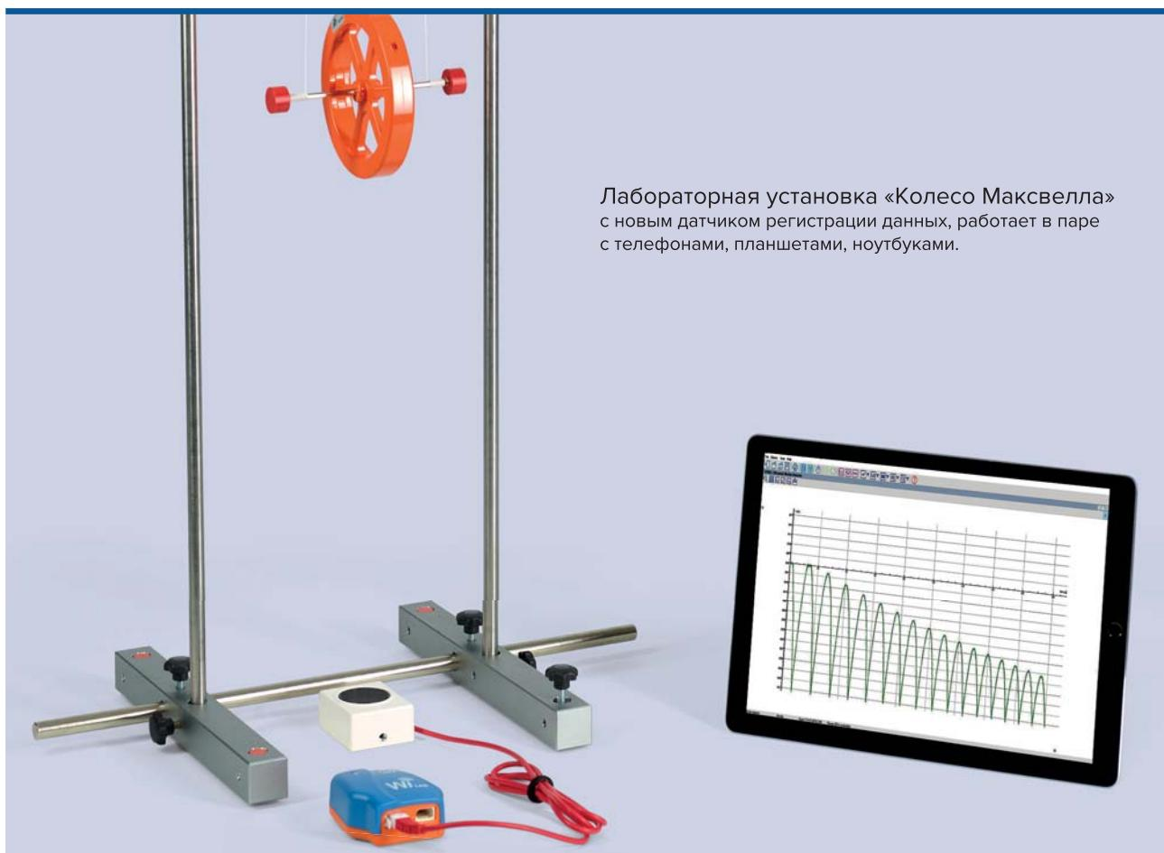
Лабораторная установка «Колесо Максвелла»
